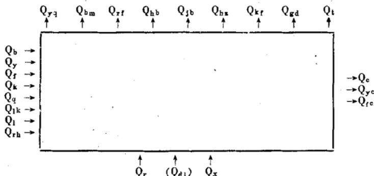
图1 热平衡方框图
