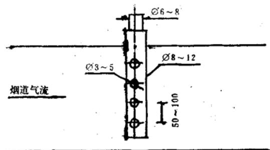
图H 取样管小孔示意图
