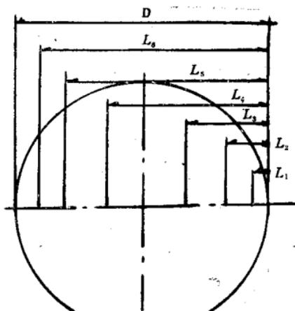
图E2 圆形管道各测点至管壁距离
