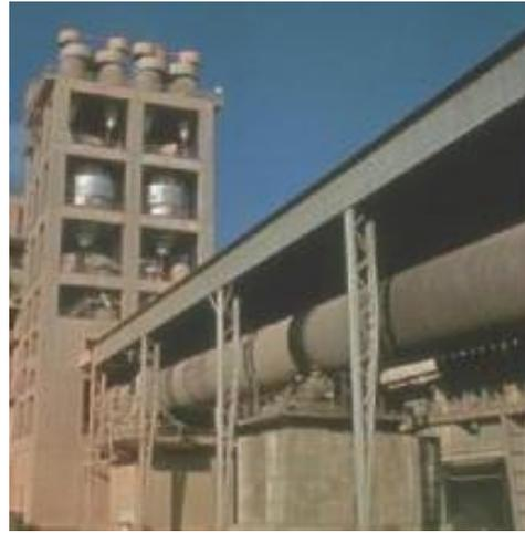
五级旋风预热器窑的照片
